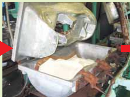
炉の中でウレタンが膨らみ成型
