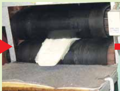
ウレタン中のガスを抜く
