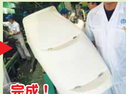
炉の中でウレタンが膨らみ成型
