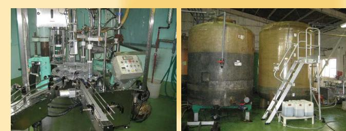
搾った生醤油を調整、加熱殺菌、さらに再度ろ過し、機械で充填します。
