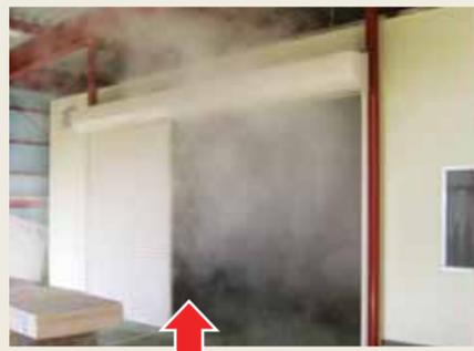
木材をパレットごとFFCの蒸気で満たされた部屋に入れます。このままの状態での蒸気による処理されます。
