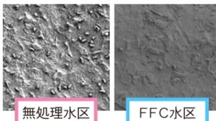
チタン板表面の様子 (電子顕微鏡写真) 多数の粒々が細菌
