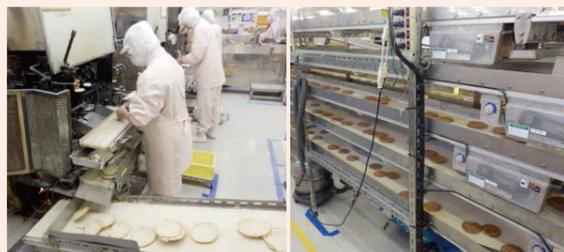
180℃の焼き型で6分間焼成され、1時間に1800枚、1日あたり、平均30万枚焼き上げます。焼き上げられたせんべいはベルトコンベアで冷やされながら運ばれます。
